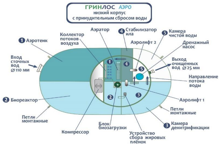
Рисунок 4. Технология очистки стоков в моделях с низким корпусом и принудительным сбросом
