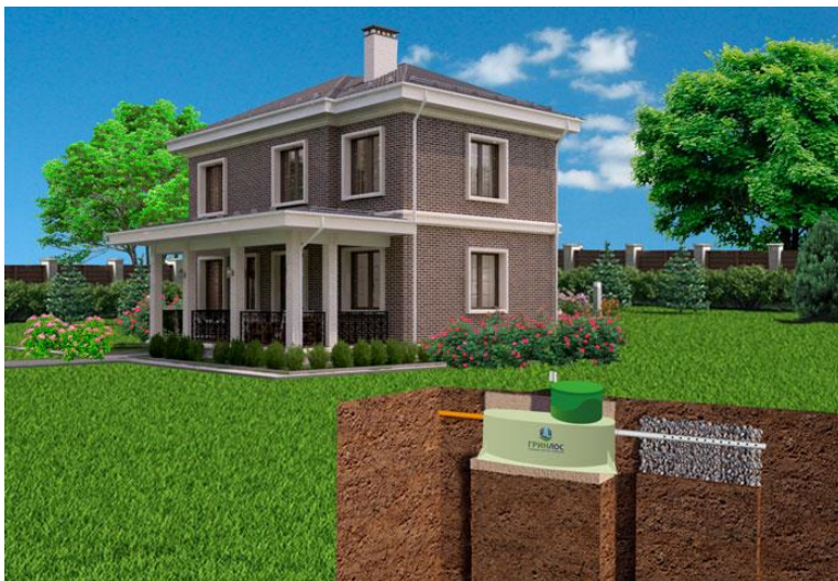
Рисунок 12. Монтаж с отводом очищенных сточных вод в фильтрующий колодец
