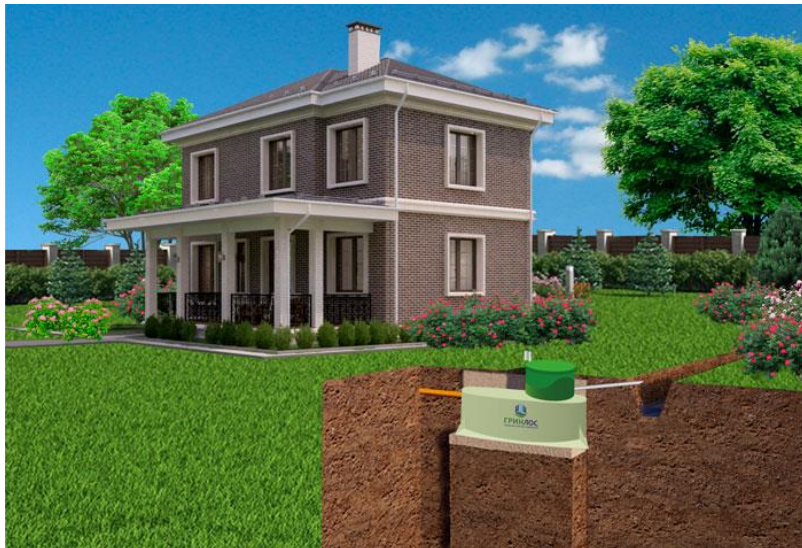
Рисунок 10. Монтаж с самотечным отводом очищенных сточных вод в дренажную канаву
