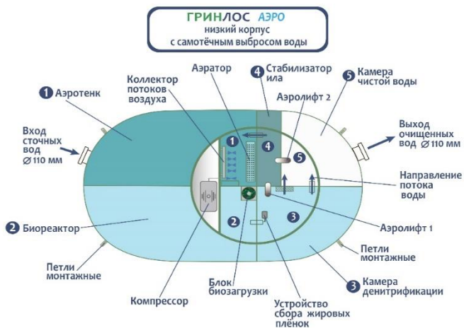
Рисунок 3. Технология очистки стоков в моделях с низким корпусом
